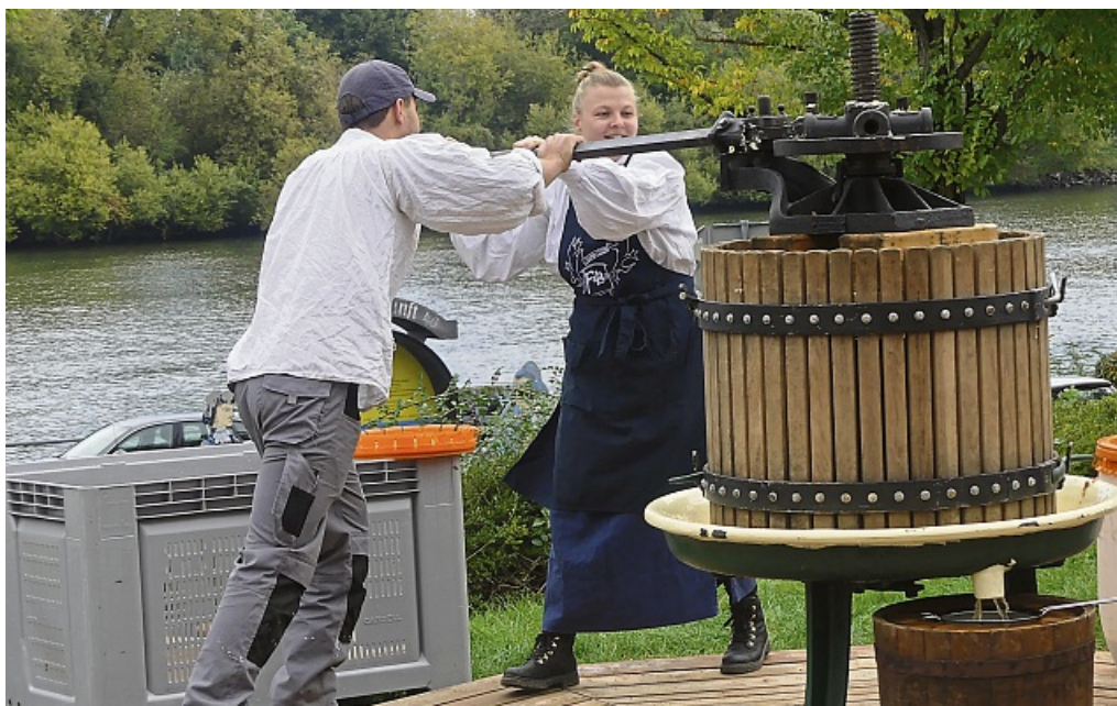
Die große Kelterpresse benötigt viel Muskelkraft, damit der Saft aus der Apfelmaische fließt.
