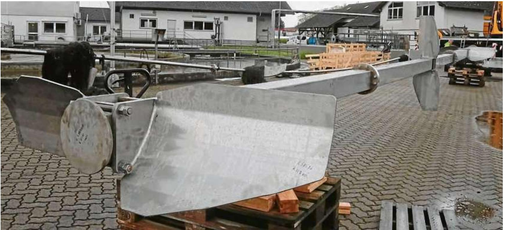
**Schwerer, stabiler, längere Lebensdauer:** das neue Edelstahl-Rührwerk für den Schleifbach-Faulturm.
