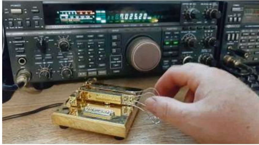
Auch das Eingabegerät für Morsezeichen ist moderner und ergonomischer geworden. Das sogenannte „Paddle“ hat die klassische Morsetaste weitgehend abgelöst. Morsezeichen können so mit geringerem Bewegungsaufwand schneller eingegeben werden.
