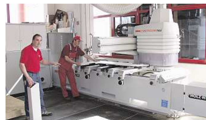
Die CNC-Bearbeitungs-Anlage ist eine computergesteuerte Fräs- Bohr- und Zuschnittanlage, welche den professionellen Möbelbau ermöglicht. Kostengünstige Bearbeitungsmöglichkeiten begeistern nicht nur den Profi, sondern auch den Heimwerker.
