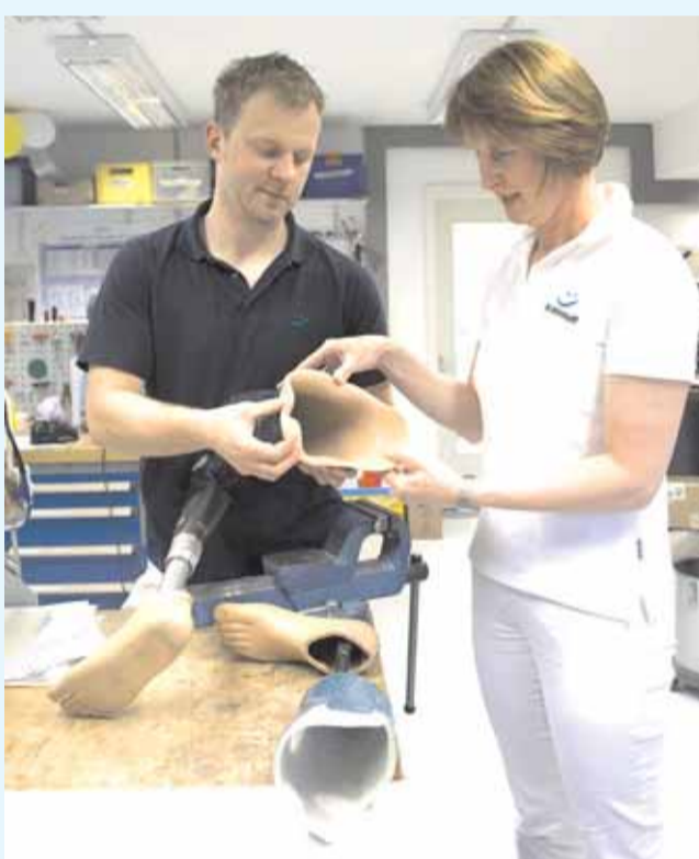
Die Orthopädietechnikermeister Margret Wilmhoff und Martin Brehm begutachten die Flexibilität eines Silikon-schaftes einer Oberschenkelprothese.
