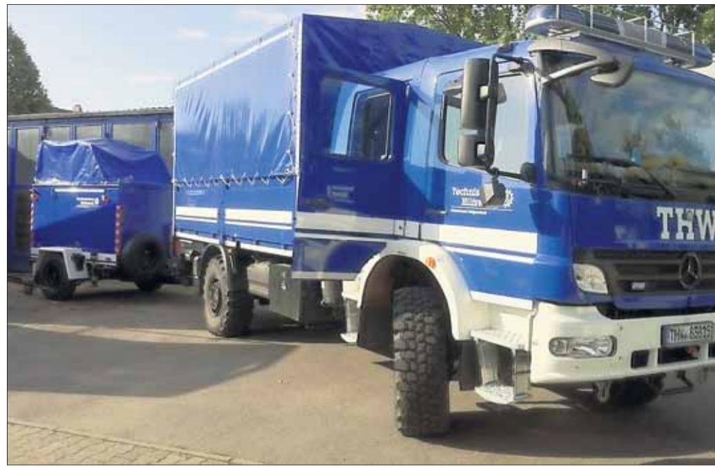
Neu beim Seligenstädter THW ist der Mannschaftslastwagen Ateco 1329 AF der Firma Mercedes Benz. Er bietet Platz für sechs Helfer zuzüglich des Fahrers und ist mit einer Leistung von 286 PS ausgestattet. Er verfügt über eine Nutzlast von fünf Tonnen. Fotos: p
