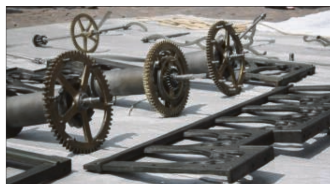
Zahnräder, große und kleine, Hülsen, ein Gestell, Gewichte und vieles mehr. 250 Einzelteile zählt die alte Rathausuhr.
